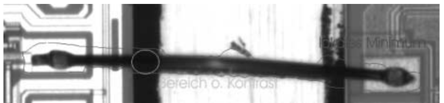
Bild 1. Bonddrähte haben teilweise keinen Kontrast zum Hintergrund
