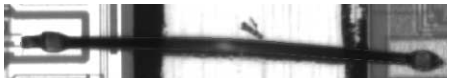
Bild 2. Die Drahtkonturen werden mit einem Modell verglichen
